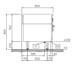
Electrical inlet (power) Equipotential screw
